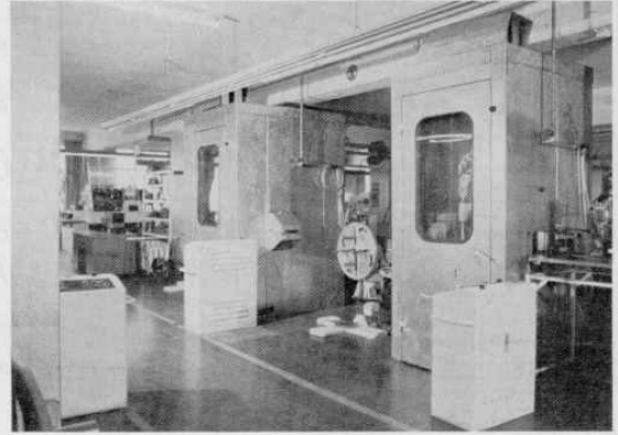
Bild 5 Die Bedienelemente der Presse stehen in Sichtweite außerhalb der Kapselung.
